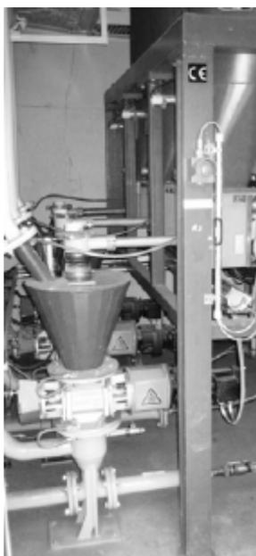
Рис. 6. Инжектор на дозирующей установке
