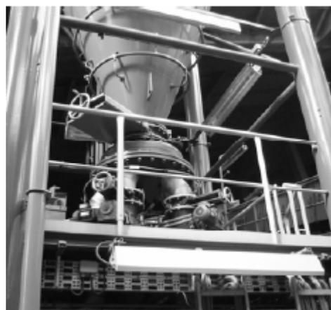
Рис. 4. Распределитель на пять дозирующих установок
