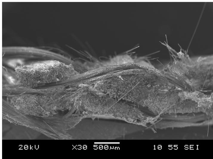
Рис.2.Боковой срез высокотемпературной ткани с микромембраной при увеличении X30.
