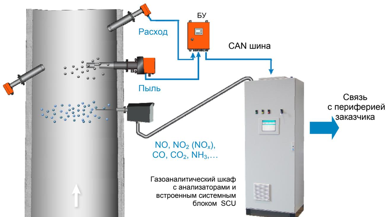
Рис. №2 Система контроля выбросов с экстрактивными анализаторами
