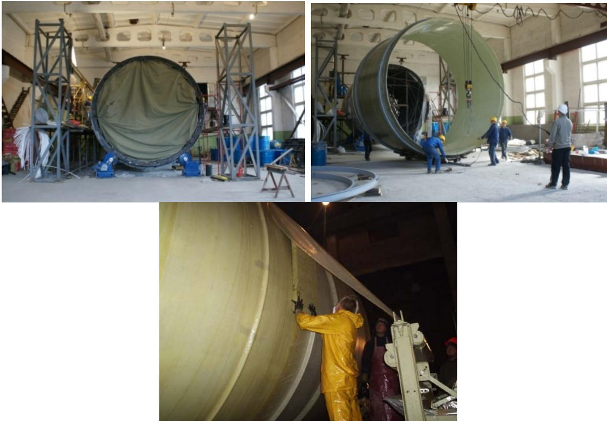
Фото 2, 3, 4. Установка для изготовления, съём готовой трубы с оправки (Кировская ТЭЦ-4), вмотка скорлуп среднего слоя сэндвичевых конструкций.
