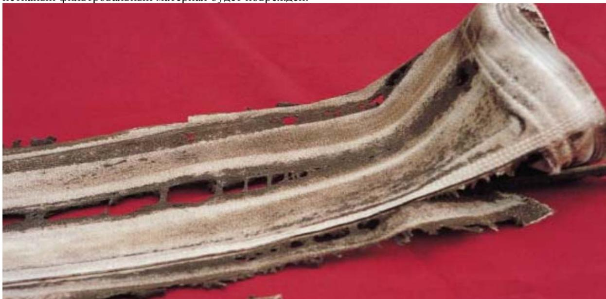
Рис. 5: *Полимерный фильтровальный рукав, частично сгоревший в процессе работы.*
