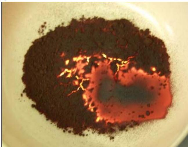
Рис. 6: Пыль с элементарными частицами железа, накаливаемыми до красного каления.
