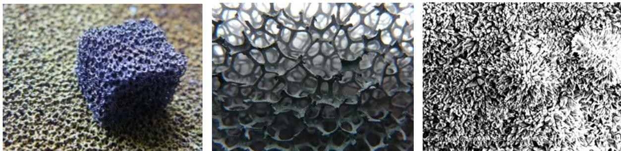
Рис. 1. Внешний вид (а), сетчато-ячеистая структура (б) и каталитическое покрытие (в) катализаторов.
