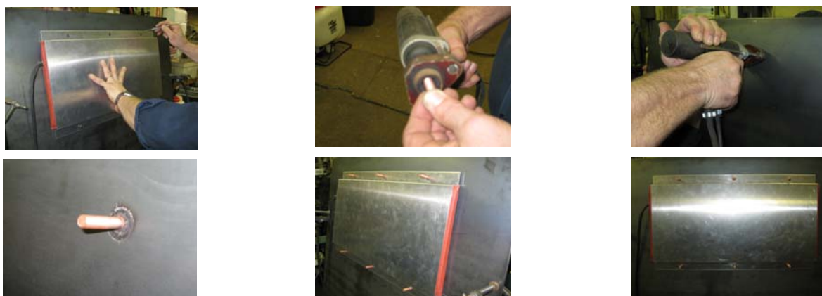
Монтаж нагревателей в высокотемпературной оболочке в металлическом кожухе
