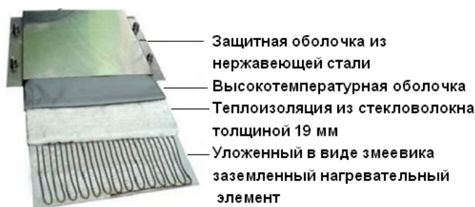
Монтаж нагревателей в высокотемпературной оболочке в металлическом кожухе
