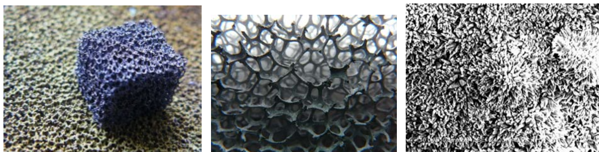
Рис. 2 Внешний вид (а), сетчато-ячеистая структура (б) и каталитическое покрытие (в) катализаторов.
