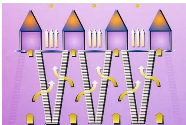
Рис. 6. Схема работы БОУ ААФ AS. Проход воздуха через фильтры.
