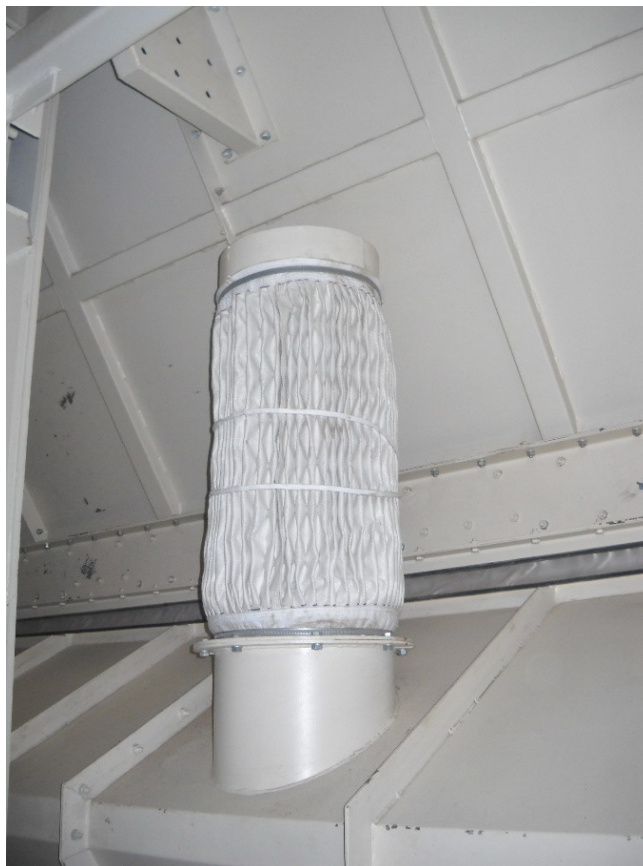
Рис. 6. 3DESA-фильтрпатрон с подачей запыленного воздуха внутрь.
