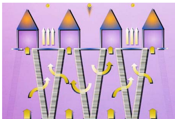
Рис. 7. Схема работы БОУ ААФ AS. Импульсная очистка фильтрующей панели.
