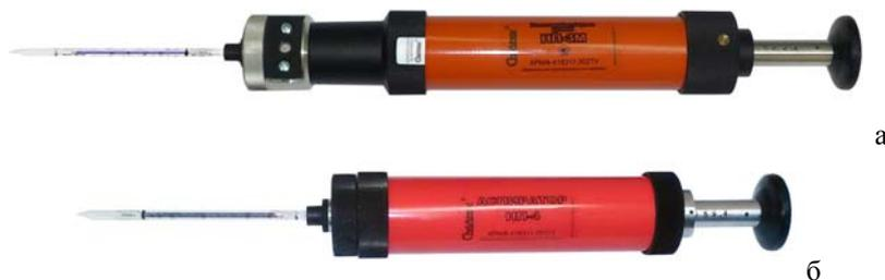
Рис. 1. Индикаторные трубки в комплекте с аспиратором типа НП-3М (а) и НП-4 (б).
