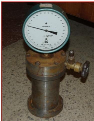
Рис. 1 Камера высокого давления
