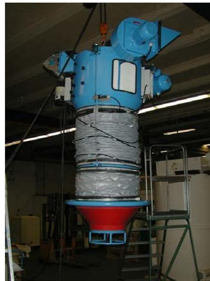
*Рис. 5. Станция погрузки сыпучих материалов.*
