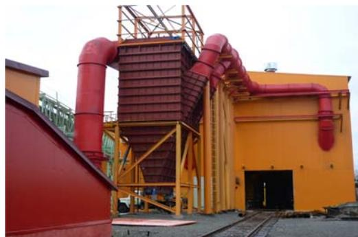
*Рис. 4. Взрывозащищенный фильтр INTENSIV, установленный в рамках*
