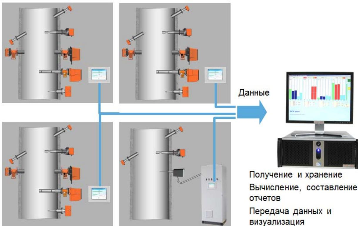
Рис.3 СНМВ на нескольких трубах
