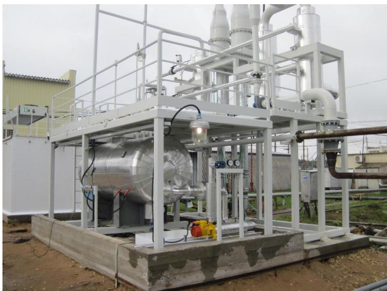
Рис.5. ККР 300 ТУ 3614-001-53976876-2009, номинальная производительность 300 м<sup>3</sup>/час.Гатчина, компания ЗАО «ЛВЖ-701». Одновременная и независимая рекуперация паров прямогонного бензина при больших и малых дыханиях резервуарного парка и при работе АСН в автоцистерны.
