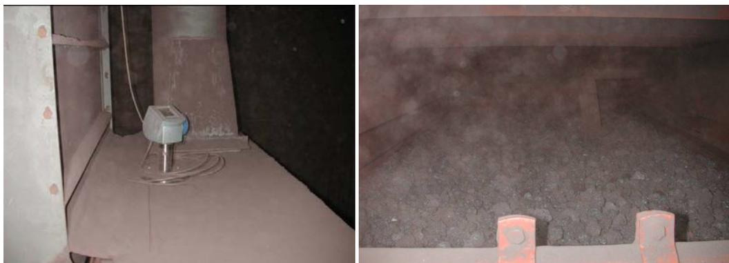
Рис.6. Применение OPTIWAVE 6300C на измерении уровня кокса на сетчатом фильтре в сталелитейной промышленности.
