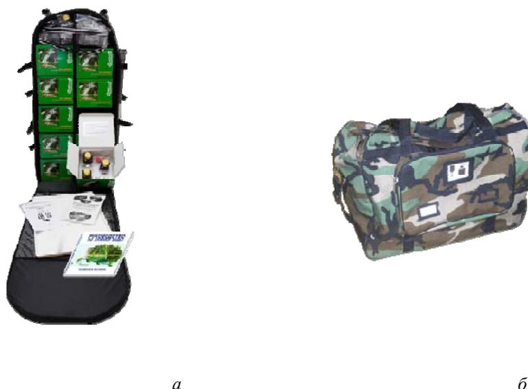
Рис. 4. Ранцевая укладка лаборатории НКВ-Р (а) с баулом, содержащим запас расходимых материалов и дополнительные модули для анализа (б).
