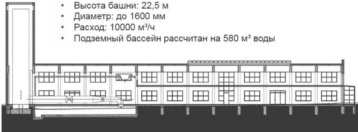
Рис.2. Расходомерная проливная установка «REFERENCE TOWER RSTR 04»
