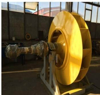
Рис. 11. Ротор нагнетателя (эксгаустера), изготовленный из биметалла SWIP®.
