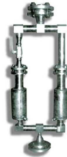
Рис.18. Вариант компоновки сепараторов СПШ в блок. Расход  $1 \text{ кг пара/с}$ , рабочее давление  $0,3 \text{ МПа}$
