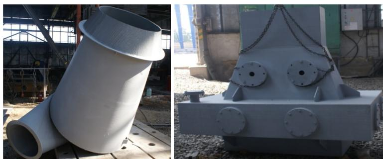
Рис. 5. Циклон-промыватель и труба «Вентури» агломерационного производства, изготовленные из биметалла SWIP®.
