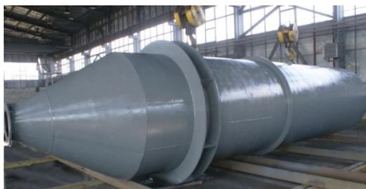
Рис. 2. Коллектор хвостовой части агломашины из биметалла SWIP®.
