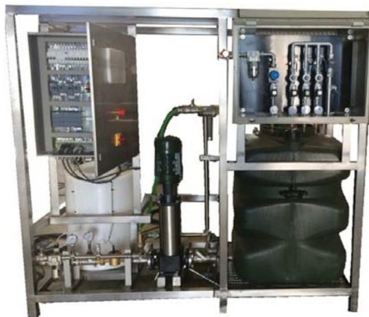
Рис.5. Рамная конструкция системы пылеподавления Spraying Systems
