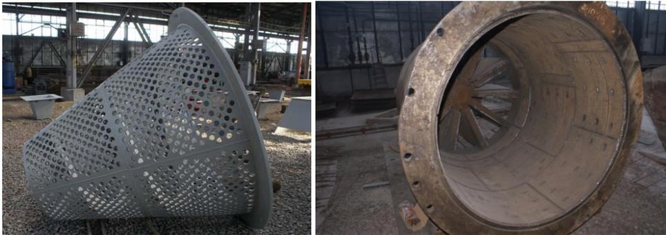
Рис. 9. Элементы шаровых мельниц рудо-обогатительных фабрик и горно-обогатительных комбинатов, изготовленные из биметалла SWIP®.
