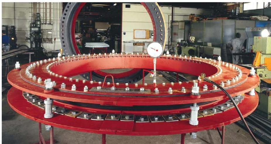
Рис. 2. Испытания на прочность резинокордового компенсатора.
