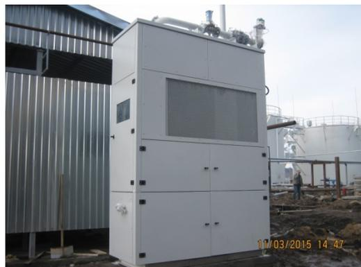
Рис.26 ККР 100М ТУ 3614-001-53976876-2014, номинальная производительность 100 м<sup>3</sup>/час. Иваново, ОАО «Ивхимпром». Рекуперация паров бензинов.
