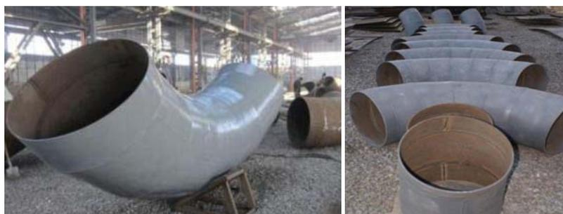
Рис. 6. Элементы аспирационной системы коксовой батареи коксохимического производства, изготовленные из биметалла SWIP®.
