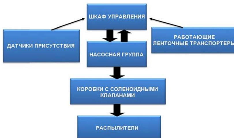
Рис.4. Принципиальный состав оборудования системы пылеподавления Spraying Systems
