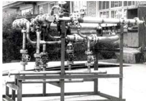
Рис.16. Пример компоновки СПВ в установке с вихревыми трубами для конденсации и сепарации попутного нефтяного газа. Производительность  $2 \text{ кг/сек}$ , рабочее давление  $1,3 \text{ МПа}$ .
