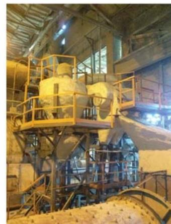
Рис.6. Центробежные фильтры в системе газоочистки цементной мельницы №10 – 3,2\*15 Балаклейского цементного завода
