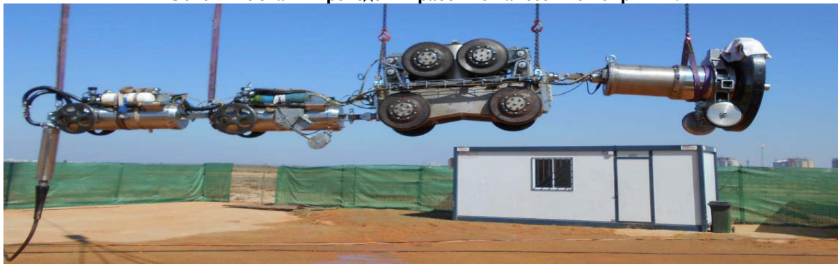
Рис. 1 . Внутритрубная диагностика методом ультразвуковой панорамной дефектоскопии
