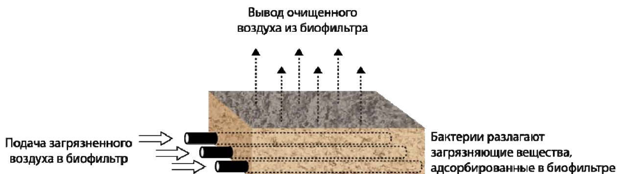
Рис. 1. Принцип процесса биофильтрации
