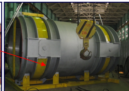
Компенсатор DN 2700 на сруббер домны Новолипецкого металлургического комбината
