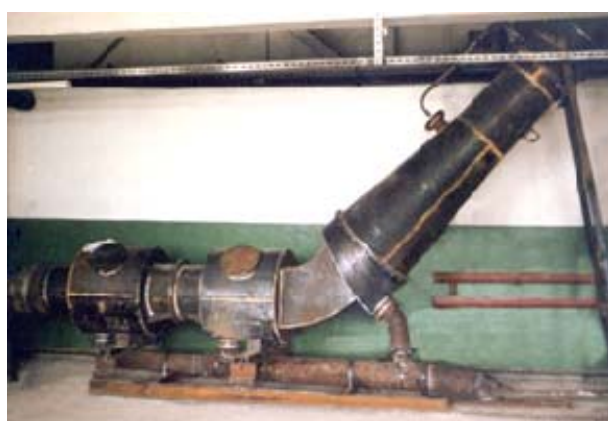
Рис. 3. ГОУ для очистки газов отходящих от установки обжига цветного вторсырья
