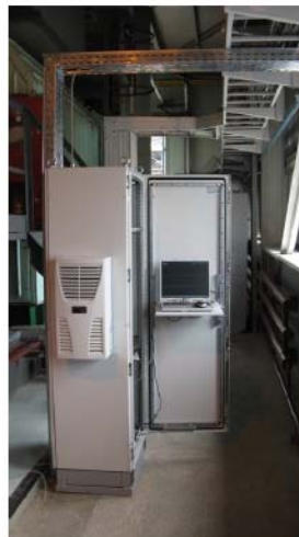
Установка пробоотборного зонда и модуля управления пробоотбором на источнике выбросов
