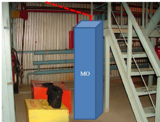
Установка пробоотборного зонда и модуля управления пробоотбором на источнике выбросов
