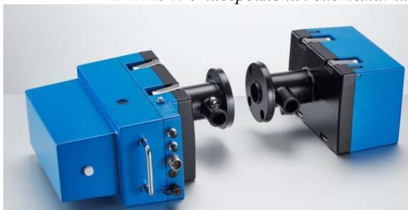
Второе поколение пылемера D-R 290 хорошо подходит для поточного контроля при комбинированном использовании топлива. Имеет широкий диапазон измерения от 0...80 до 0...4000 мг/м<sup>3</sup>, а также возможную температуру эксплуатации до 1000°C, превосходя по этим показателям все остальные пылемеры из линейки Durag. Имеет полупроводниковый источник излучения с длительным сроком службы. Может управляться с помощью блока D-ISC 100.
