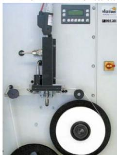
Применяется для влажных газов, доменного дутьевого газа. Возможно дополнительное измерение содержания тяжелых металлов. Опционально возможно применение зонда с разбавлением пробы для высоких концентраций пыли или после влажных скрубберов. Позволяет производить измерения в малодоступных вытяжных трубах малого диаметра.
