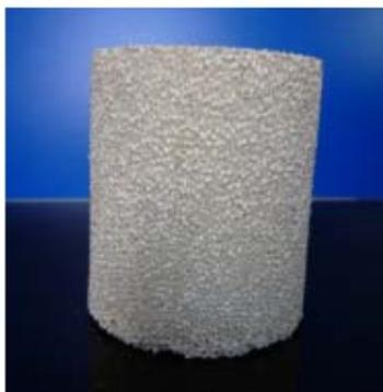
Рис.7. Внешний вид фильтра-сорбента
