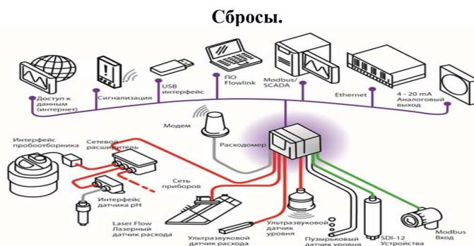
Рис. 3. Возможная конфигурация узла контроля за сбросами.
