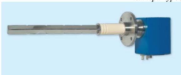
Удачное решение для совместного измерения концентрации пыли (трибоэлектрическим методом), расхода (методом перепада давления), температуры, абсолютного давления. Не применяется непосредственно после электростатических осадителей. Возможно применение на газоходах минимального диаметра 0,3 м.
