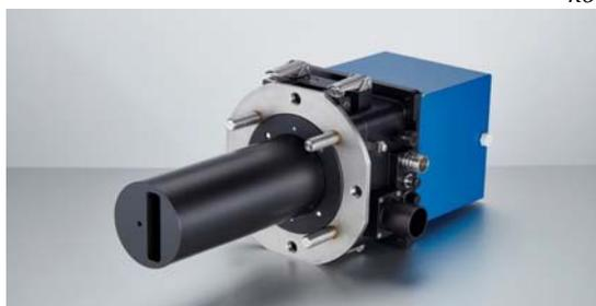
В данном приборе нового поколения благодаря применению метода обратного рассеяния света обеспечивается возможность одностороннего монтажа оборудования. Отлично подходит для задач измерения пыли в диапазоне до 200 мг/м<sup>3</sup>, может работать до температуры измеряемой среды до 600°C. Имеет возможность работы в газоходах диаметром до 20 м, в чем превосходит все остальные пылемеры из линейки Durag. Может управляться с помощью блока D-ISC 100.
