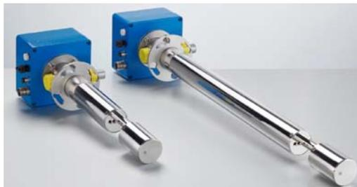
Преимущество прибора D-R 800. Реализует метод прямого рассеяния света. Может успешно применяться для газоходов с малым диаметром, а также для толстостенных газоходов. Устанавливается только на одной стороне трубы. Имеет шкаф электропитания с интегрированной установкой продувки воздухом. Может управляться с помощью блока D-ISC 100
