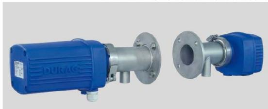
Второе поколение пылемера D-R 220 позволяет экономично измерять концентрацию пыли в широком диапазоне (до 0...4000 мг/м<sup>3</sup>). Не требуется применения кожухов для защиты от атмосферных воздействий излучателя и отражателя. Имеет шкаф электропитания с интегрированной установкой продувки воздухом. Комплект оборудования имеет небольшую общую массу. Может управляться с помощью блока D-ISC 100.
