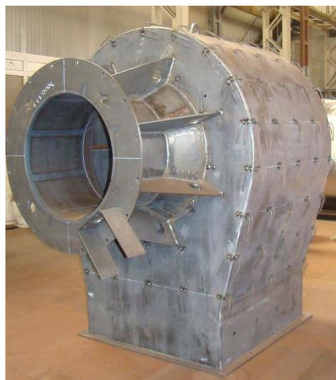
Рис. 7. Изготовление воздушного короба горелочного устройства ZeecoFreeJet на российском заводе
