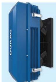
В данном оборудовании применяется метод обратного рассеяния и реализуются измерения малых концентраций сажи и пыли. Имеется функция автотестирования системы и коррекции измеряемых величин, а также самокалибровки каждые 4 часа.
